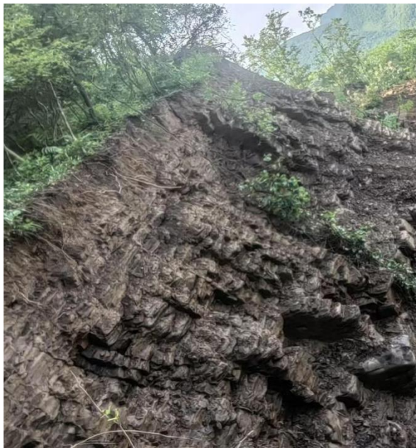
照片 1 右后缘滑壁岩体破碎
