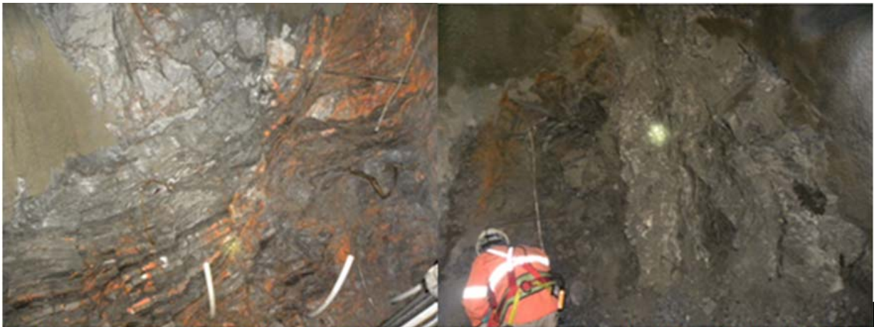
图片 1-3 赋存于 F_3 的 ③号矿体。矿体位于 F_3 上盘，矿体穿过断层边界进入上盘围岩，15 线 400m 标高。
